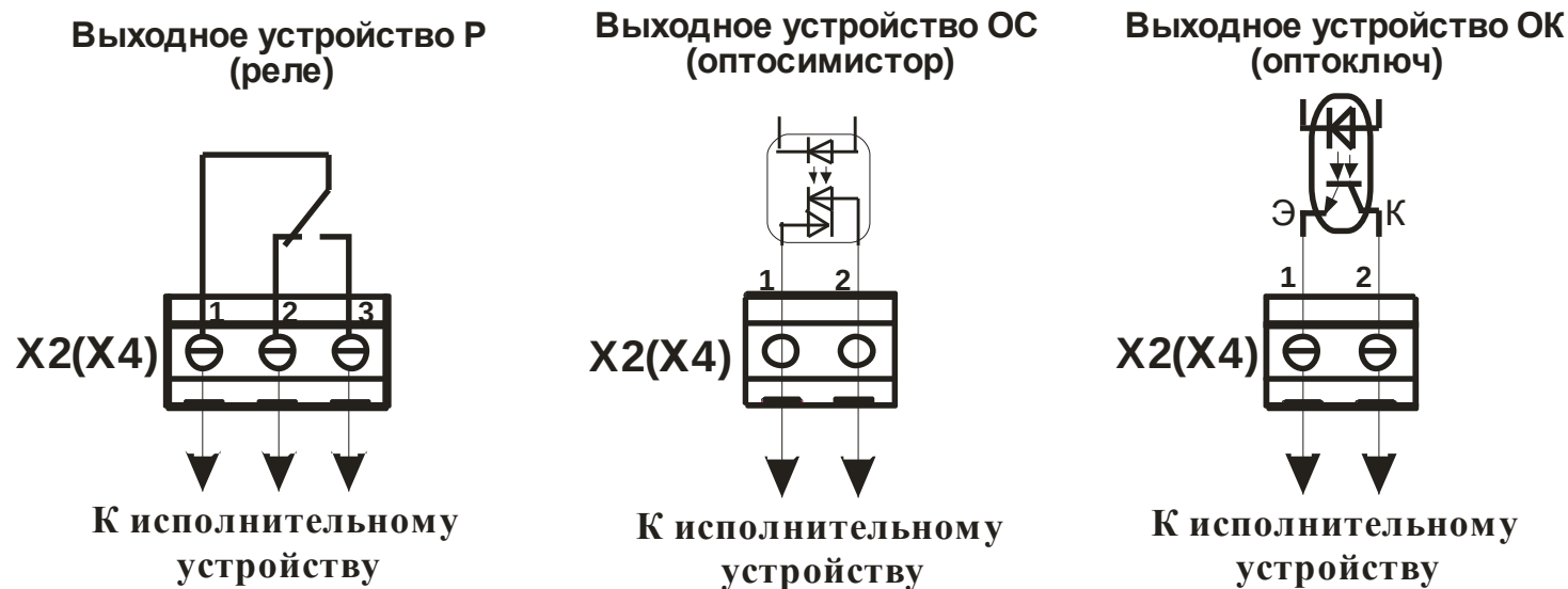
Рисунок 8.2 – Схемы подключения различных выходных устройств
